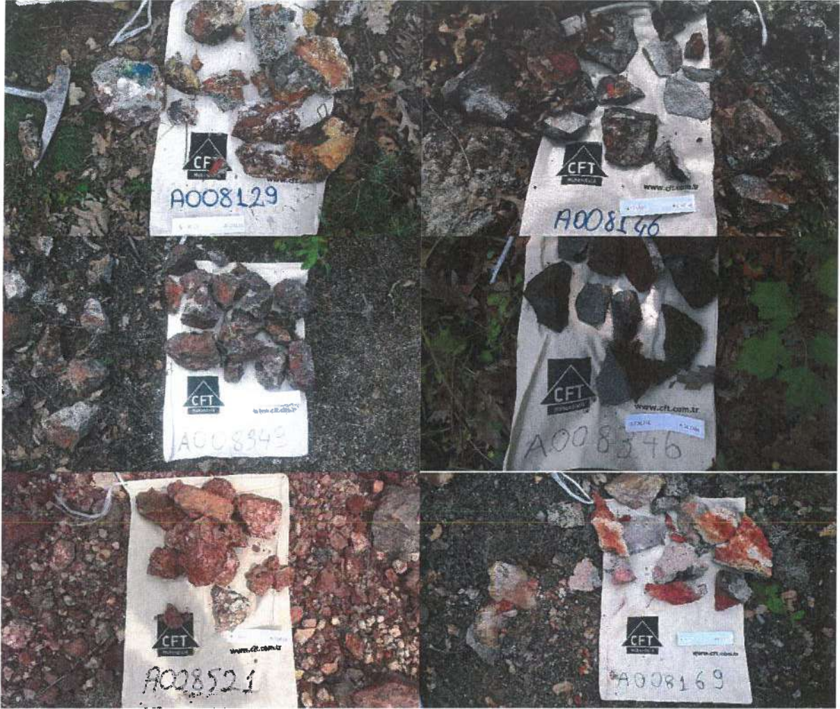
Şekil- 38. Mineralleşme Türlerini Gösteren A008129, A008146, A008343, A008346, A008521 ve A008169 Numaralı Kaya Örneklerinin El Örneği Görüntüsü
